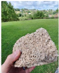
Un mélange de chaux et de chanvre qui recouvre le sol de la nouvelle extension.
